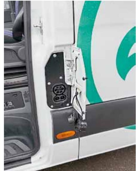
**Der ehemalige Tankeinfüllstutzen wurde zu einer Ladebuchse umfunktioniert. Hier wird mit einem CCS2-Stecker „aufgetankt“. Leider gibt es am Steckplatz selber keine Anzeigen über den Ladezustand, dieser kann nur am Fahrzeugdisplay abgelesen werden.**
