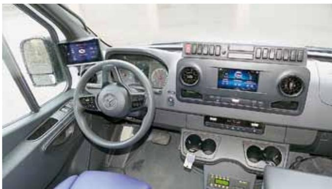
**Der originale Sprinter-Fahrerarbeitsplatz wurde nur leicht verändert und erhielt einen zusätzlichen Monitor auf der linken Seite. Dort erhält der Fahrer die Information z. B. über den Batterieladezustand und die Restreichweite.**
