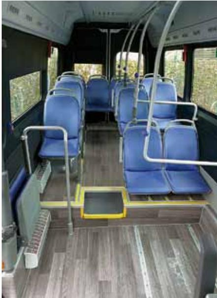
Der Sprinter City 45 Electric ist mit 14 Sitzen ausgestattet, wovon sich einer als Klappsitz am Stehperronbereich in Fahrtrichtung rechts hinter dem Einstieg befindet.
