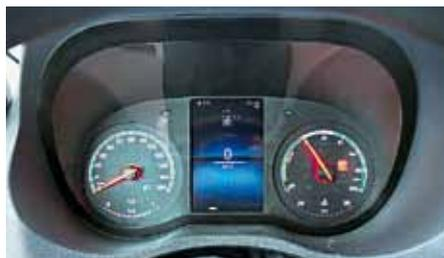
**Die alten Displayanzeigen wurden mit neuen Folien versehen, die eine ebuspezifische Anzeige erhielten.**
