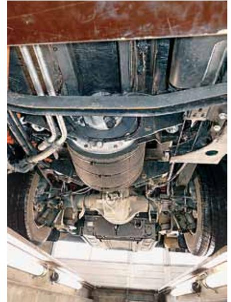
Ein Blick von vorne nach hinten: Der Elektromotor sitzt vor der Hinterachse im Bereich des ehemaligen Retarders. Dahinter ist das dritte Batteriepaket zu sehen.
