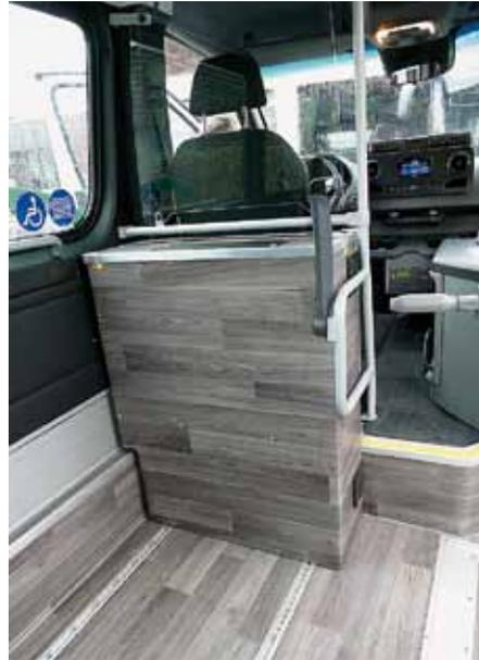
Das beim Prototyp im Stehbereich positionierte Batteriepaket wird in der Serie unter dem dann etwas vergrößerten Fahrerpodest verschwinden.
